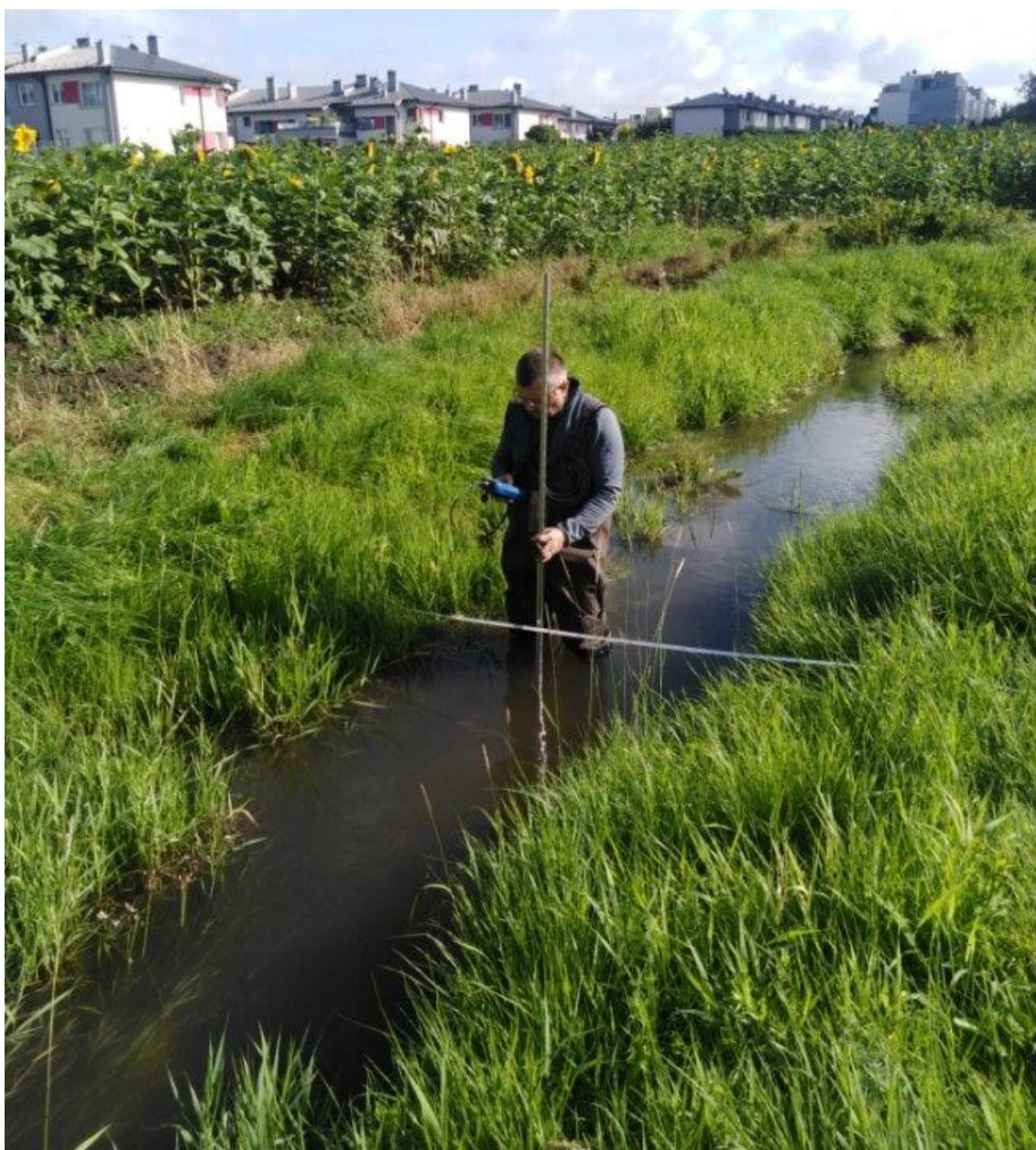
Fot. 1 Pomiar przepływu na Rowie Jeziorki
